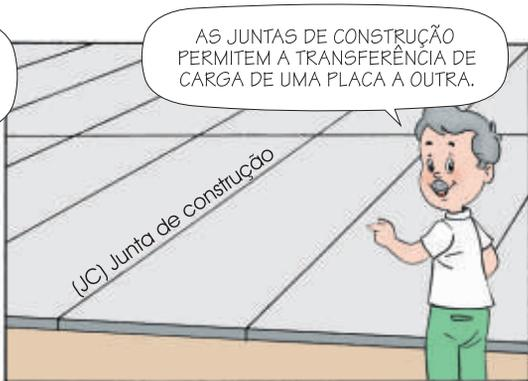
A FUNÇÃO BÁSICA DAS JUNTAS É PERMITIR AS MOVIMENTAÇÕES DE CONTRAÇÃO E EXPANSÃO DO CONCRETO.
