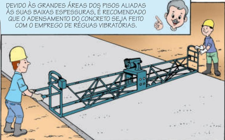
NA REGULARIZAÇÃO DA SUPERFÍCIE DO CONCRETO É EMPREGADO O RODO DE CORTE, CONSTITUÍDO POR UMA RÉGUA DE ALUMÍNIO OU MAGNÉSIO.
