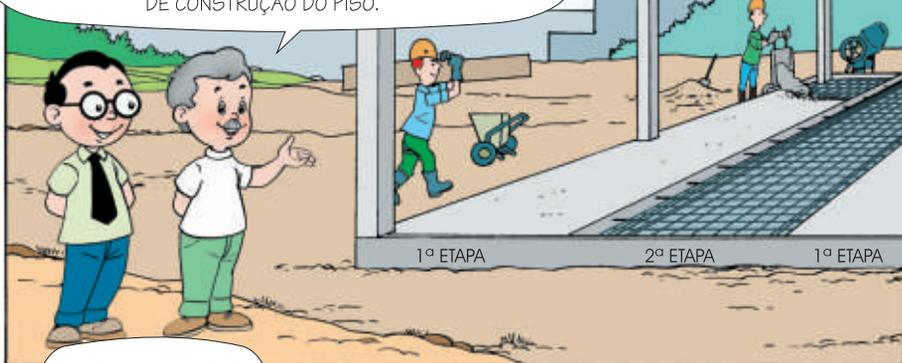
ANTES DA 2ª ETAPA DA CONCRETAGEM, DEVE-SE ISOLAR UMA PLACA DA OUTRA APLICANDO PINTURA DE CAL OU DESMOLDANTE NA LATERAL DA PLACA JÁ PRONTA.
