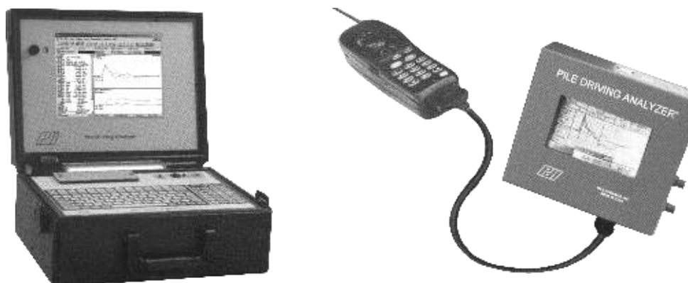
Fotografia 11 - Equipamentos PDA para processamento dos sinais dos transdutores acoplados à estaca
