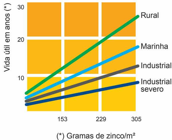
\* Máximo de corrosão vermelha na superfície da chapa
